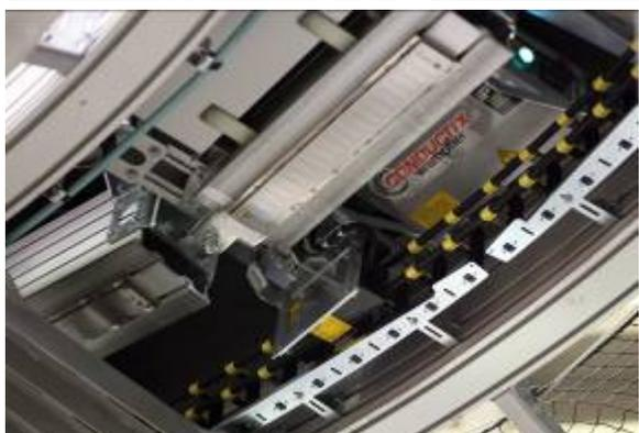
*BU: IPT® (Inductive Power Transfer) von Conductix-Wampfler beim Einsatz in einem Sorter.*
