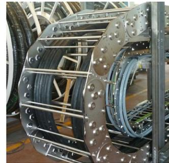
Chaîne linéaire en acier inoxydable AISI 316L pour une application offshore - Programme LZ97 et LZ96 + câbles
