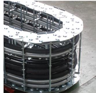
Chaîne du programme LZ98 avec flexibles. Cette chaîne est montée et transportée couchée sur son flanc en utilisant une structure acier
